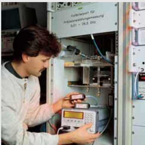
Die Kalibrierung der Messköpfe R&S ® NRV-Z ist auf die Normale der Physikalisch-Technischen Bundesanstalt rückführbar
